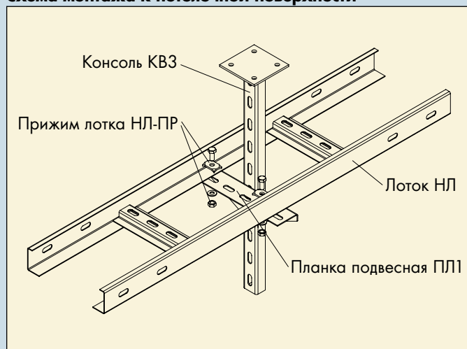
Схема монтажа к потолочной поверхности
