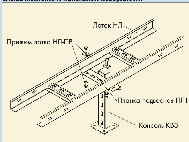
Схема монтажа к напольной поверхности
